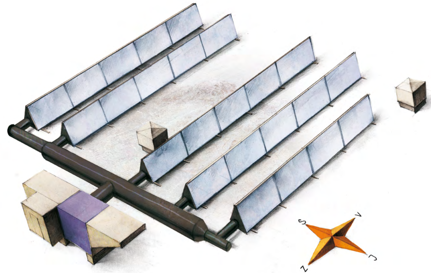
Obrázek 3. - Řady kolektorů systému SolarVenti Industrial® připojené k přívodu vzduchu
